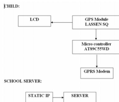
Fig: PROPOSED SYSTEM BLOCK DIAGRAM
